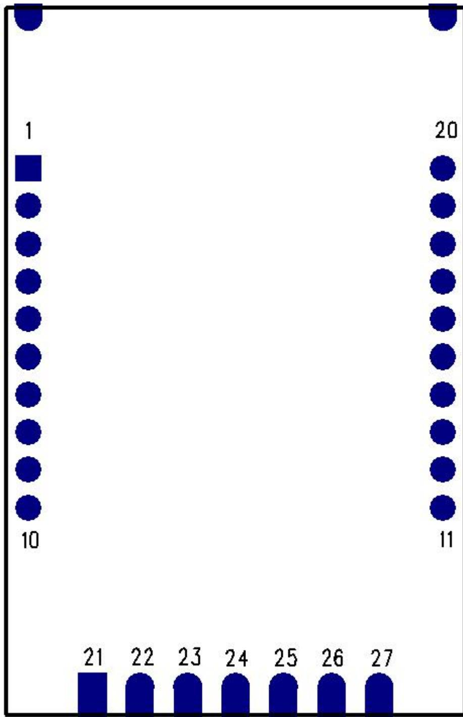
Figure 2-1 Module Pin Diagram F8L10D-N \ F8L10D-E
